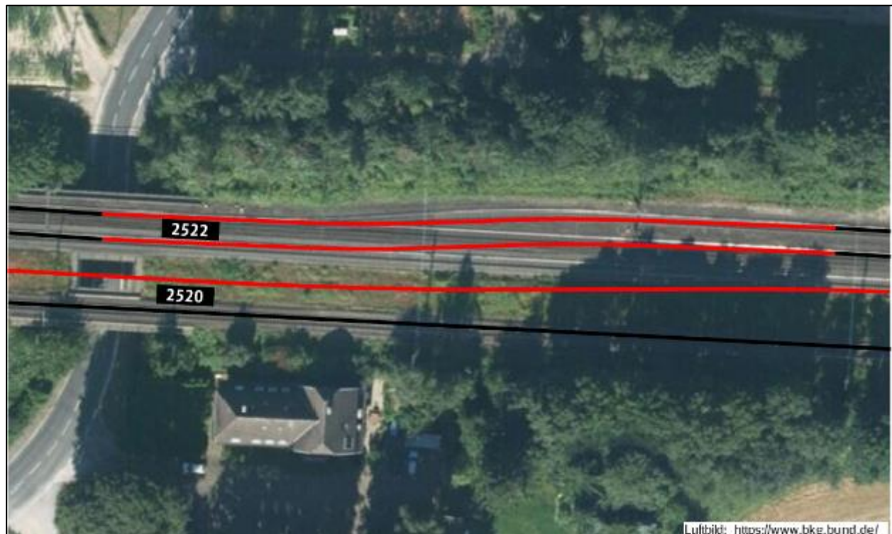
Abbildung 27: Luftbildausschnitt Viersen-Helenabrunn mit möglicher Gleisachsenverschiebung
